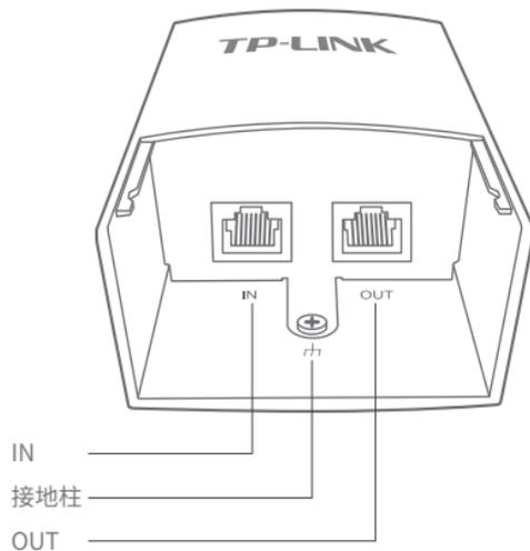
IN: RJ45端口, 连接远端设备。
